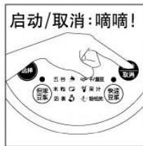
触摸相应的按键选择相应功能程序，每次选择机器都伴有“嘀”一声提示音，对应功能指示灯（或图形指示灯）亮并闪烁，触摸“启动/取消”键启动制作程序，机器伴有“滴滴”两声提示音，提示程序已启动。
